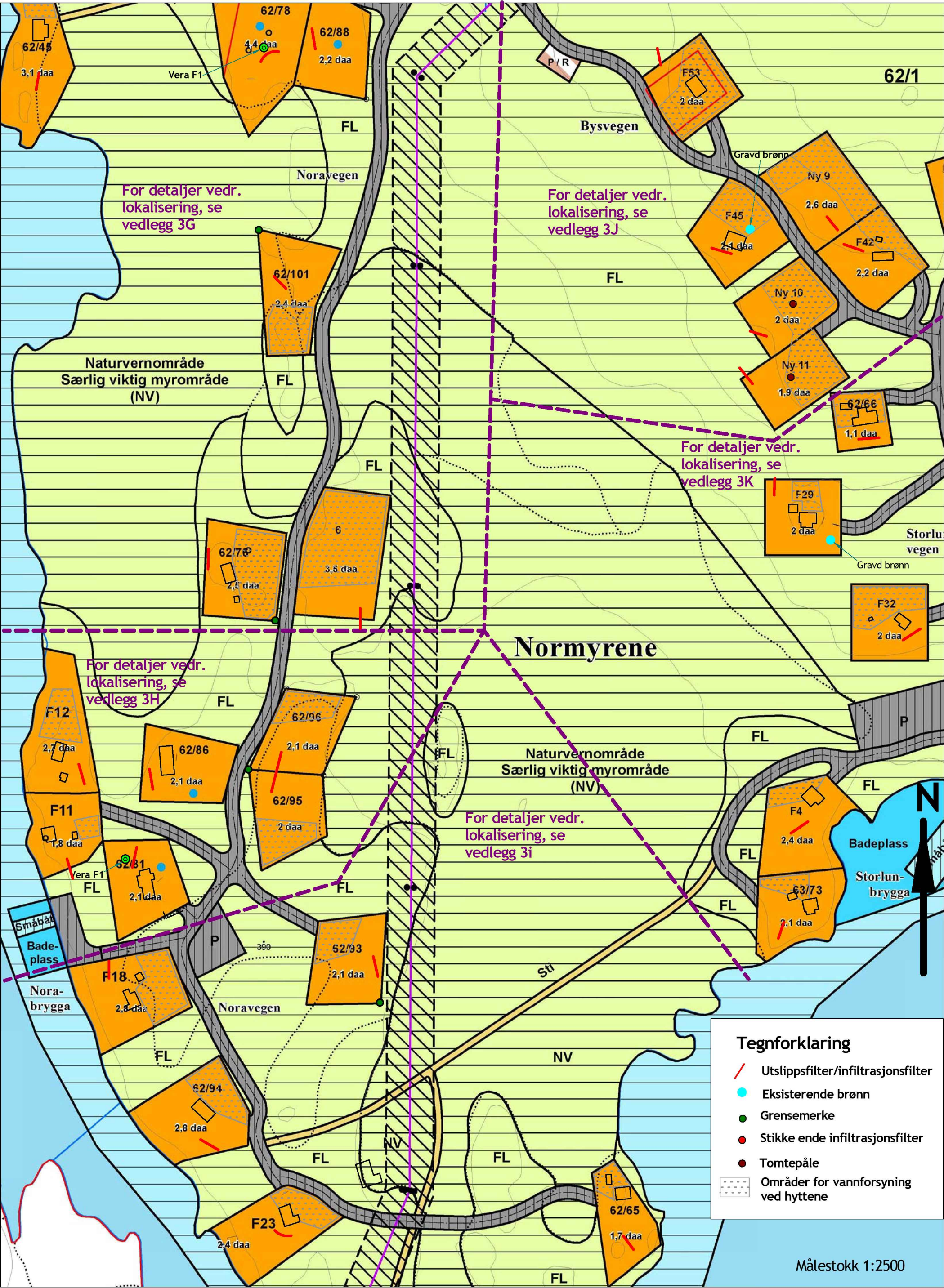
Del av reguleringsplane By Skog og Ringstad hyttefelt i Søndre Land kommune med forslag til infiltrasjonsfiltre inntegnet på kartet. Kummer som inngår i avløpsanlegg settes ned inntil hytta. Filteret lokaliseres som vist på kartet. Eksisterende brønner og forslag til lokalisering av nye brønner er også vist på kartet.
