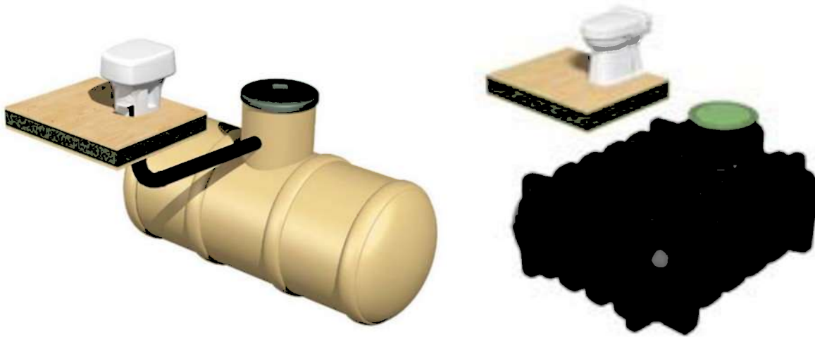
Figur 10-1: Prinsippskisser av samletanker for toalettavløp
