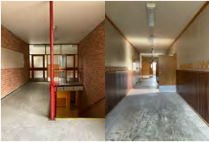
Bygningen har brede korridorer som gjør universell utforming og brannrømning enkelt å løse. Gangene kan også bli sosiale soner mellom leilighetene.
